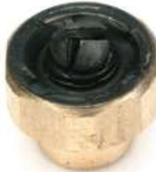
図 5 固着した安全弁のケレップ
