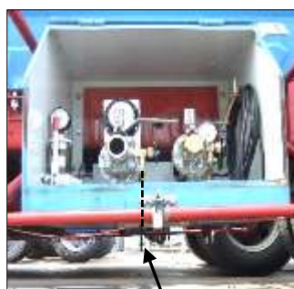
放出管(外部にでていること)
