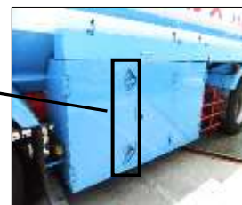
操作箱のロック装置
