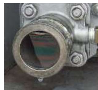
発泡液の膜 (シャボン玉の原理)
