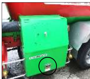
操作箱のロック装置
