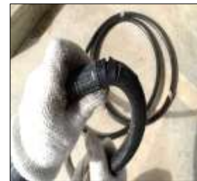
1箇所繰返し使用による割れ
