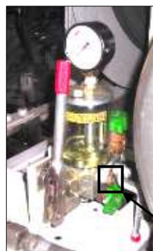
緊急遮断弁のヒューズメタル
