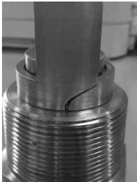
写真 1 同型式元弁の割れの状態
