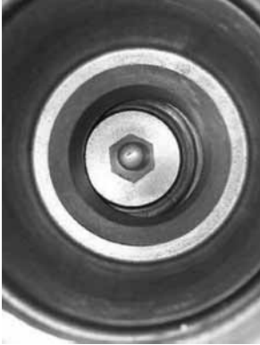
写真4 事故品元弁の軸ズレの状態
