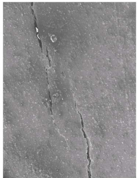
胴部の表面状態（軸方向のき裂及び鎖状腐食）
