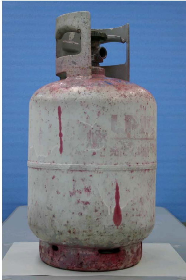
胴部の表面状態（軸方向のき裂及び鎖状腐食）
