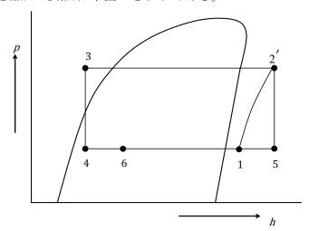
(2) 蒸発器の入口に絞り膨張してバイパスされる冷媒蒸気の比エンタルピー  $h_s$  (kJ/kg)は、
