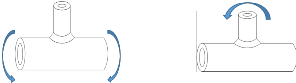
a) 主管へ曲げモーメントが作用する場合 b) ノズルへ曲げモーメントが作用する場合
