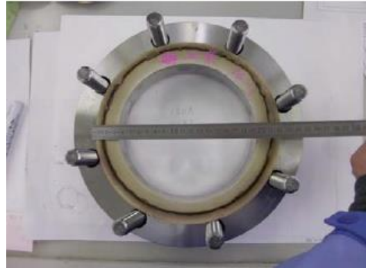
FIC-301 オリフィス下流側フランジガスケット
