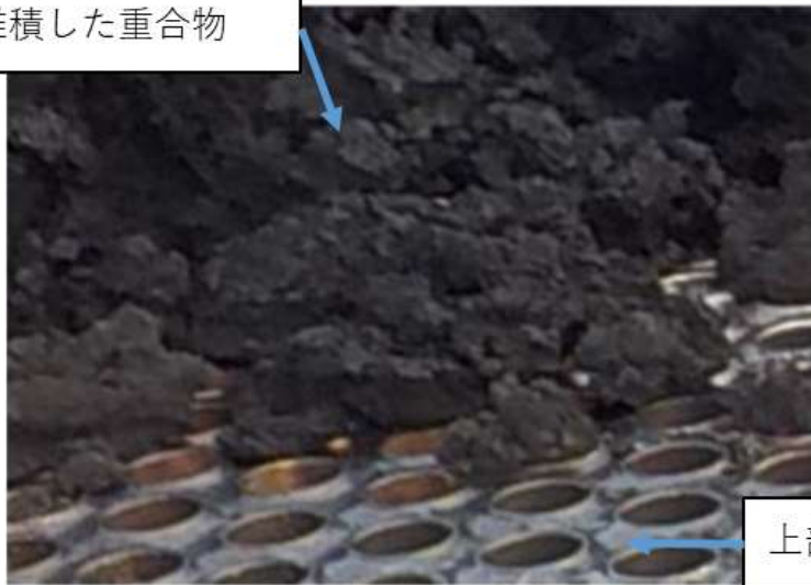
図3 上部管板に落下し、堆積した重合物
