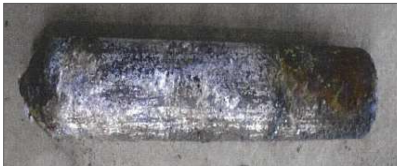
図 3 掘削後の埋没容器 2 本(上の写真からガスが漏えい)
