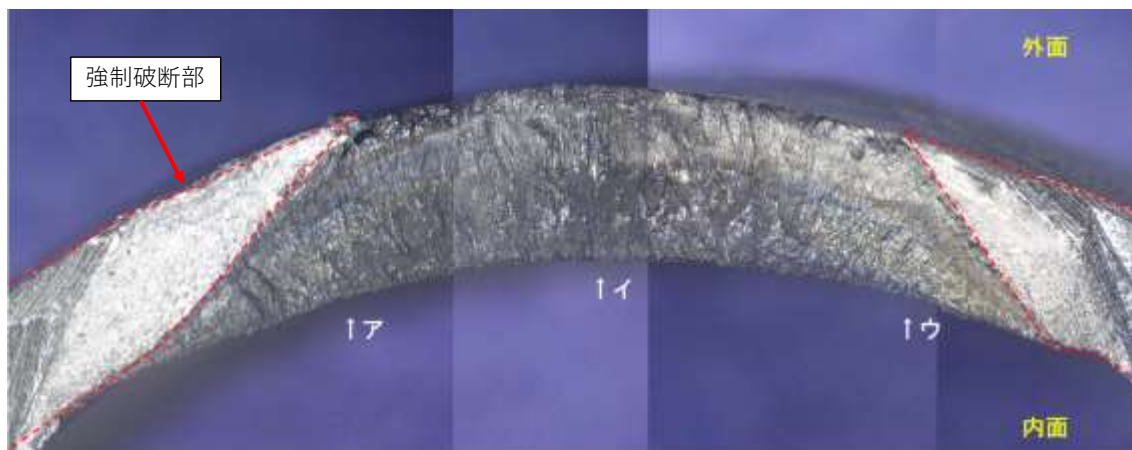
図 8 破面(酸洗浄後)
