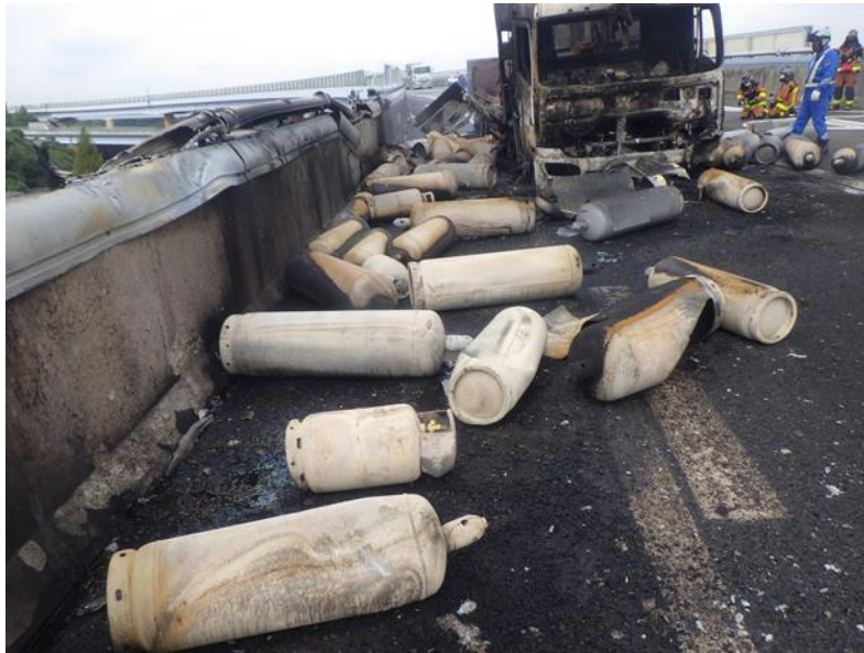
図3 焼損した車両と液化石油ガスの充填容器など (豊田市消防本部 提供)
