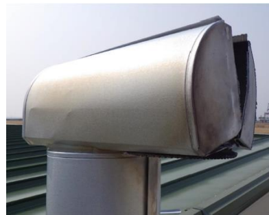
図3 水素の燃焼と保温外装板の破裂状況
