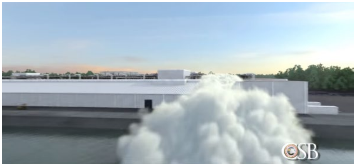
(図5) 放出されたアンモニアによる雲が、地を這うように移動拡散する様子 (CG 画像) (CSB 映像からキャプチャー)
