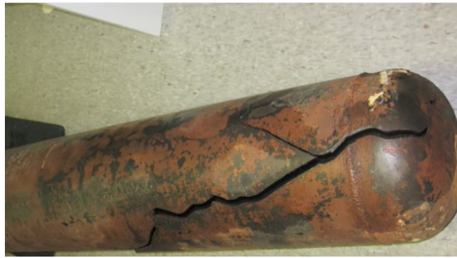
(図3) 油圧衝撃で破裂した実物の配管 (CSB 映像からキャプチャー)
