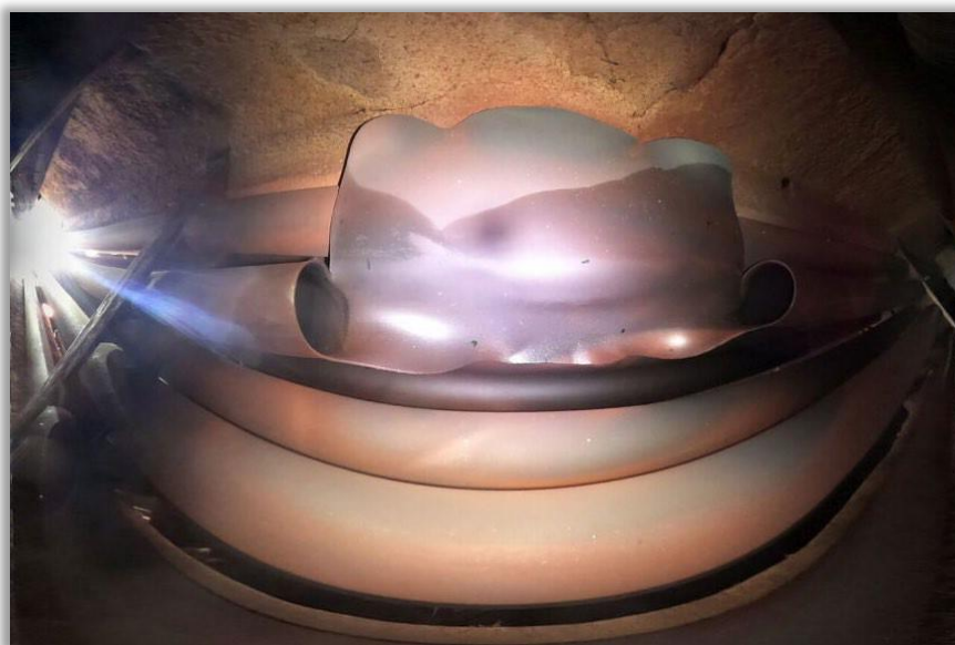
図3：事故後の加熱炉管の画像（上から見た図）（出典：マラソン社）
