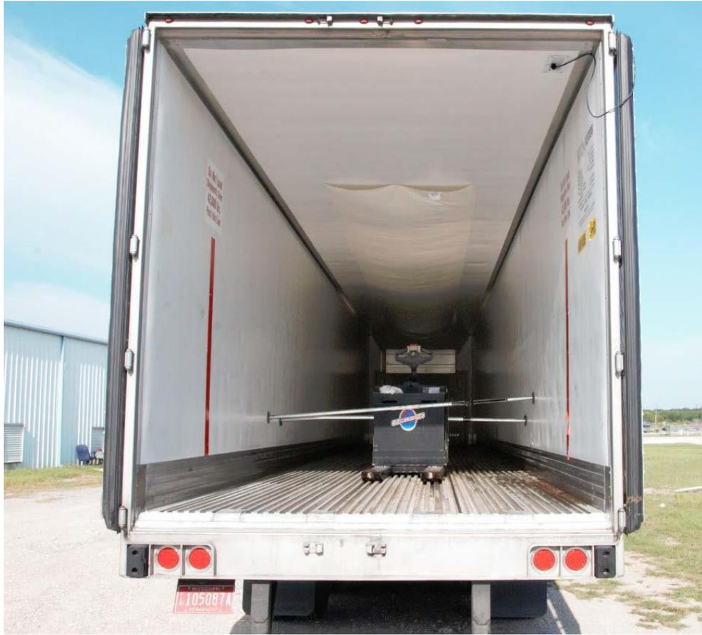
図7：冷蔵トラックトレーラー。アルケマは、有機過酸化化物製品の顧客への輸送や、低温倉庫の一つまたは複数で低温状態を維持できない場合の一時的な保管場所の提供を目的として、このような冷蔵トラックトレーラーを約12台使用していた。（出典：CSBの写真）
