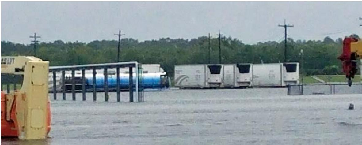
図32：高台に置かれた有機過酸化化物用の冷蔵トレーラー。この写真は、2017年8月29日（火）、ハリケーン・ハービーによる高水位の洪水の中、有機過酸化化物製品を収容し、アルケマ・クロスビー施設北側の高台に設置されていた冷蔵トレーラーである。この場所にあった6台のトレーラーは2017年9月3日の管理燃焼の際にすべて焼却された。（出典：アルケマの写真）
