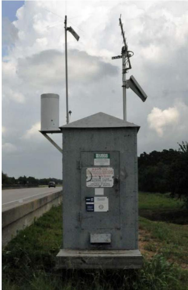
図47：観測ステーション1740。この観測ステーションは、バブラーシステムを使用し、シーダーバイユーが高速道路90号線と交差する地点（アルケマ・クロスビー施設の北東約3マイル）の水位を測定する<sup>a</sup>。（出典：CSB写真）
