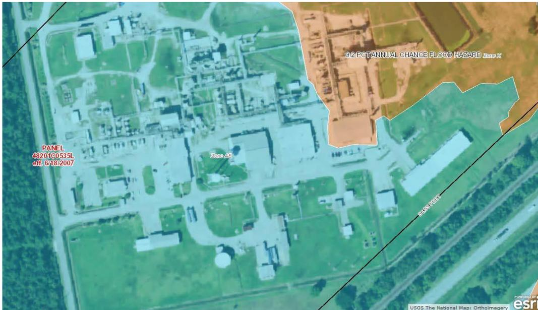
図52：100年氾濫原にあるアルケマ・クロスビー施設南部。このデジタル画像は、アルケマの電力供給設備および有機過酸化物の冷蔵施設がある南部の区域が、100年氾濫原に含まれることを示している。地図の青色部分は「ゾーンAE：100年氾濫原」を示している [58]<sup>a</sup>。
