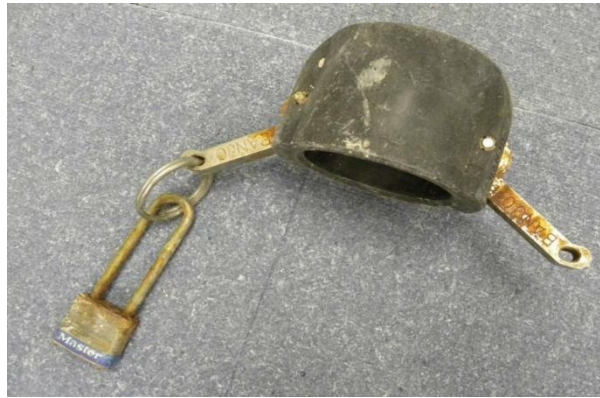
図7：スプリットリングが外れた次亜塩素酸ナトリウムダストキャップ。スプリットリングが無いと、ダストキャップを南京錠で固定できなかった（出典：CSB）
