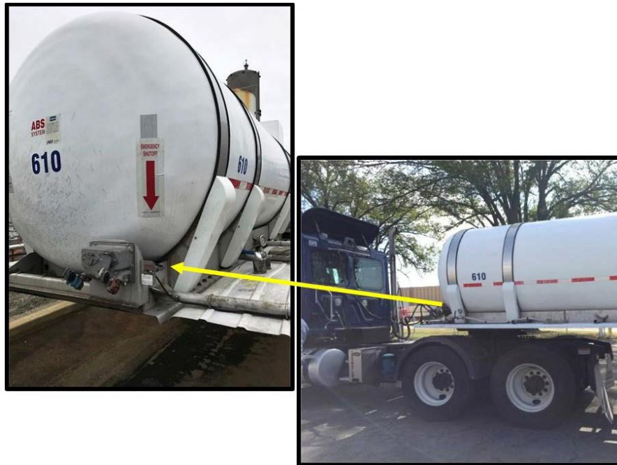
図16：ハークロスのCTMV（右）と緊急遮断スイッチ（左）（出典：ハークロスおよびCSB）
