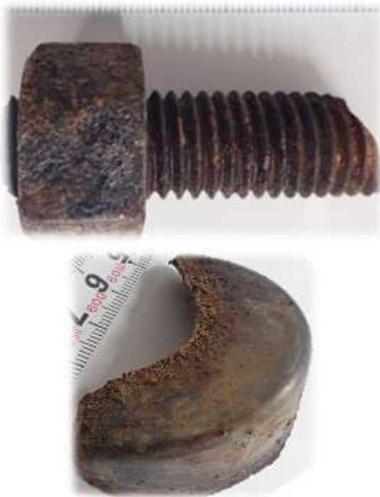
(b) 脱落したボルト及び吹き飛んだ膜ボディのかげら
