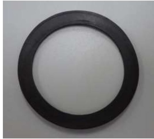
図 3 事故後のガスケットの変形状況 (左:使用していたガスケット、右:新品のガスケット(参考))
