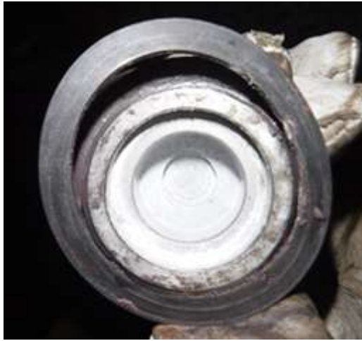
図 3 事故後のガスケットの変形状況 (左:使用していたガスケット、右:新品のガスケット(参考))
