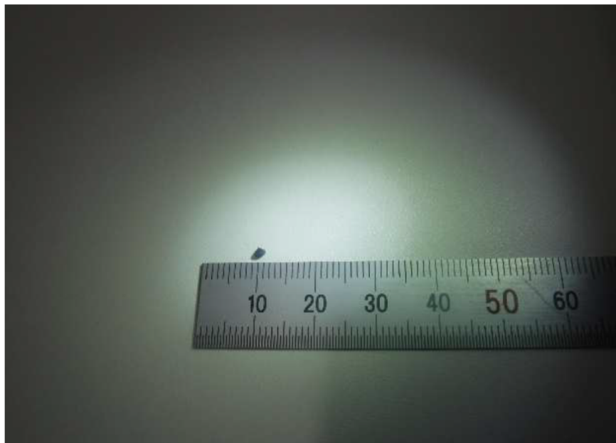
図2 安全弁の弁体と弁座のシール部に噛み込んだスケール
