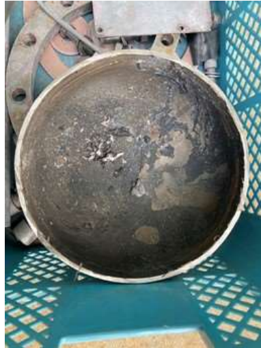
図5 事故後のポンプの状況(外槽の底部(内面))
