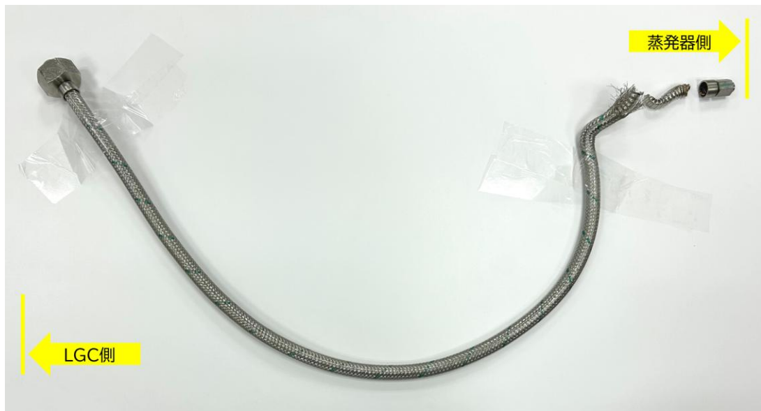
図 2 破裂したフレキシブルチューブ
