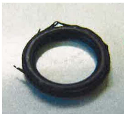
写真 損傷したOリング
