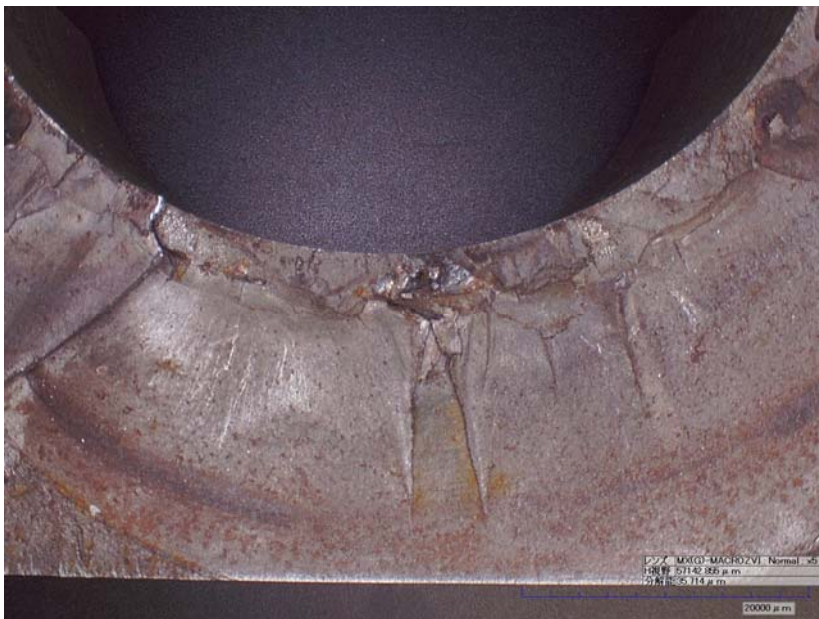
図7 ケーシングは断面(拡大) (高圧ガス保安協会 作成)
