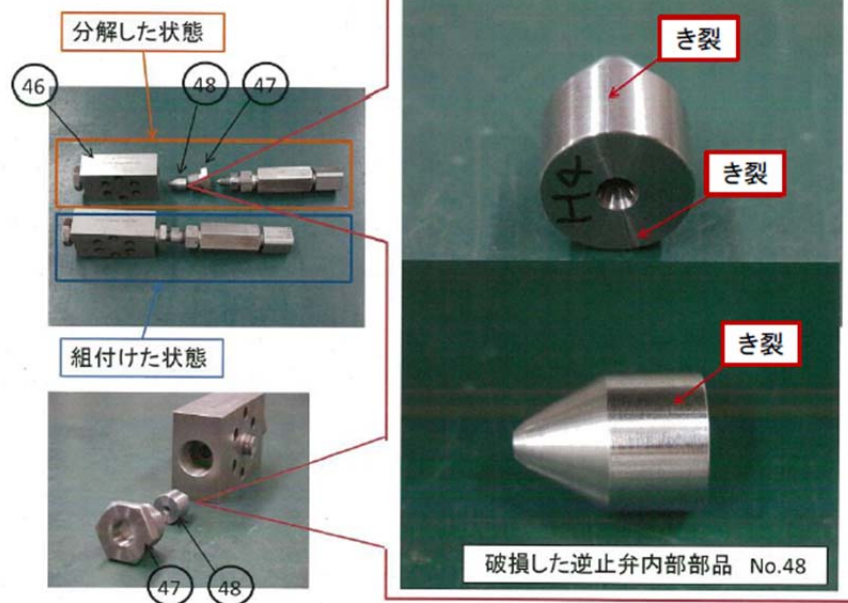
図2 破損した逆止弁
