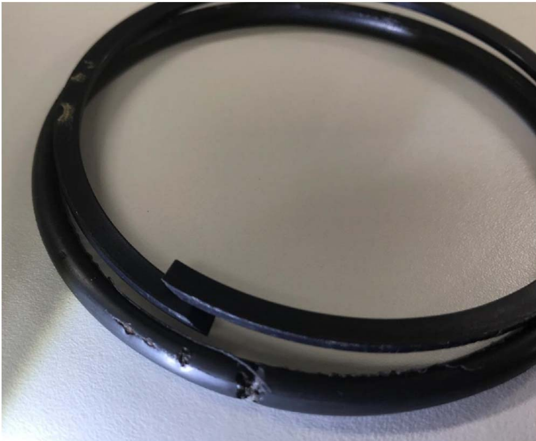
図3 損傷したOリングおよびバックアップリング
