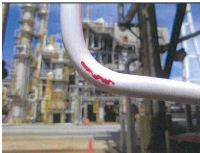
図3 浸透探傷試験結果
