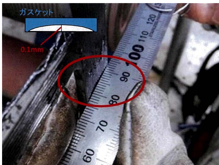
図2 ガスケットの凹み(0.1mm)
