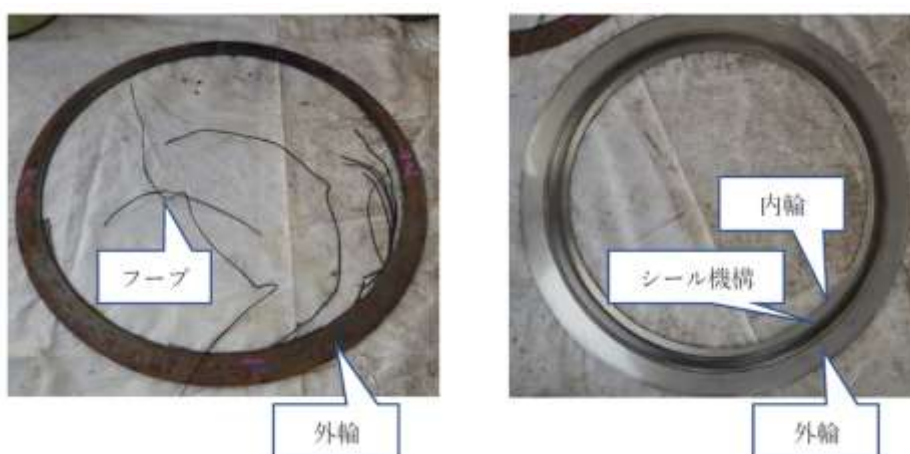
図3 第一反応塔の入口フランジ継手で使用していたガスケットの損傷状態 (左:使用していたガスケット、右:新品のガスケット(参考))
