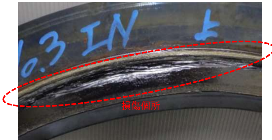
図6 第三反応塔の入口フランジ継手で使用していたガスケットの損傷状態
