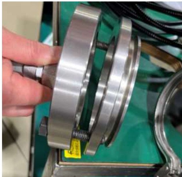
図2 変形していない耐圧試験用の治具(比較のため)
