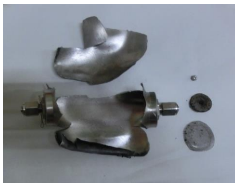
図3 爆発したガス精製器
