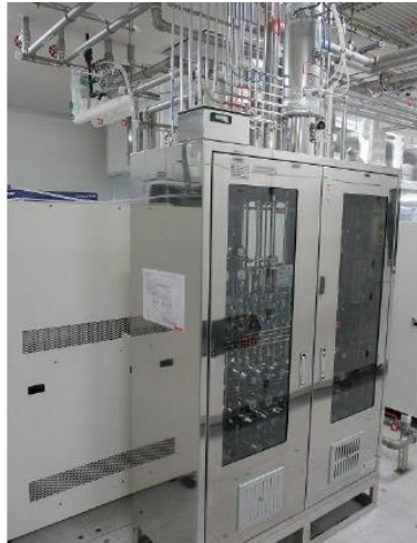
図1 MO-CVD(有機金属気相成長)装置のガスボックス
