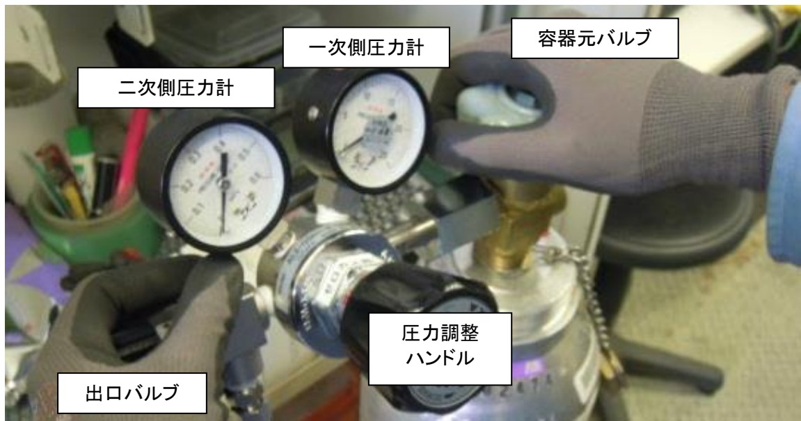
図1 パージ洗浄実施時の作業再現(事故後に撮影)
