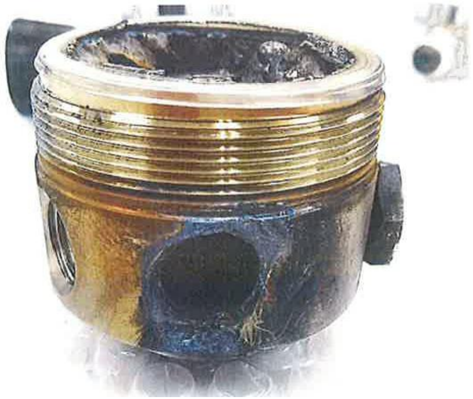
図 5 焼損した圧力調整器の出口ポート(出口バルブ側)
