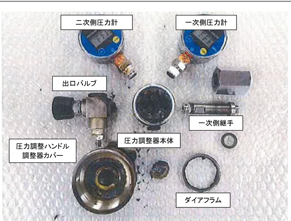
図 3 焼損した圧力調整器の分解写真
