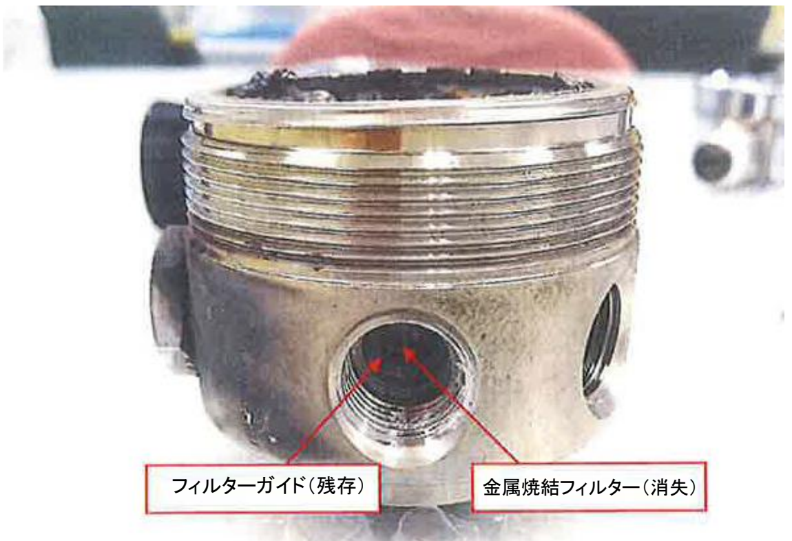
図 4 焼損した圧力調整器の入口ポート(容器バルブ側)
