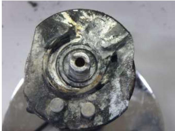
図 6 調整器の分解検査結果(附属品側から見たボドックシール)
