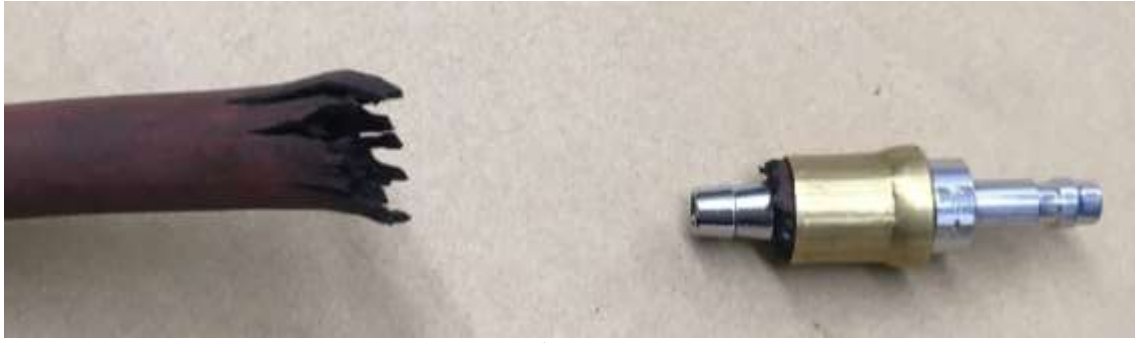
図 5 ホース破裂後に炎を発見した箇所
