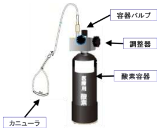
図 1 在宅酸素装置のシステム
