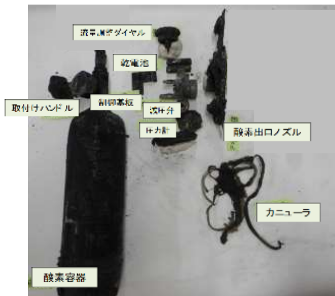
図 3 現場から回収された事故物件（大阪市消防局 提供）
