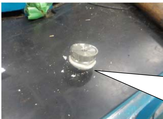
図4 液逃がし弁の分解整備状況
