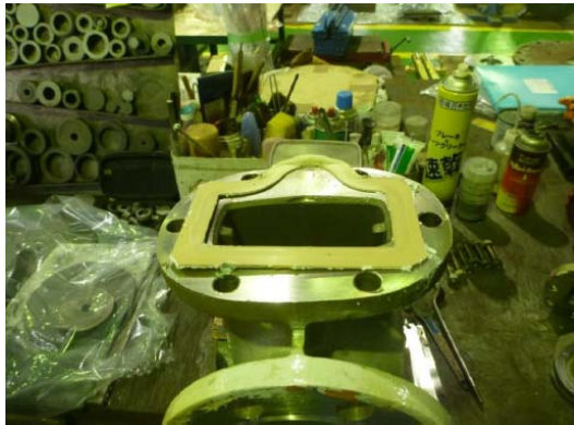
図3 漏えいが発生した仕切弁の分解整備状況
