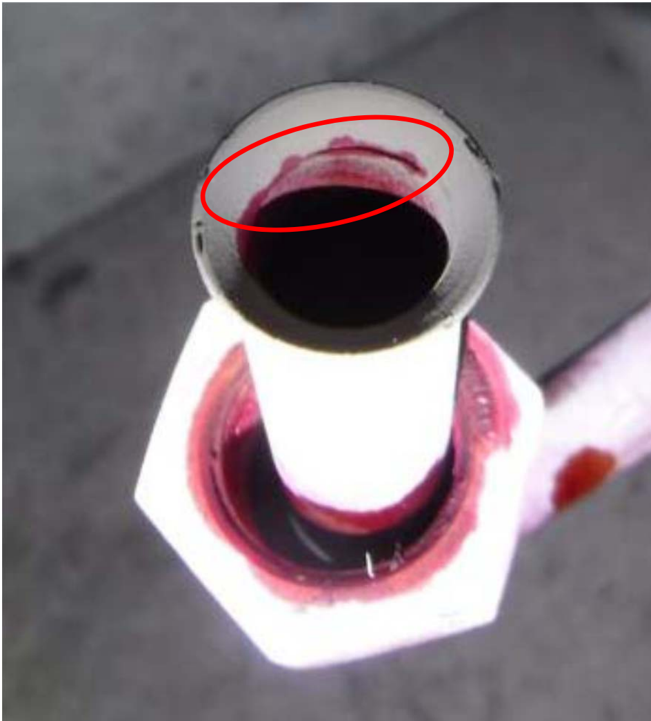
図4 配管継手(フレア式継手)の亀裂発生箇所
