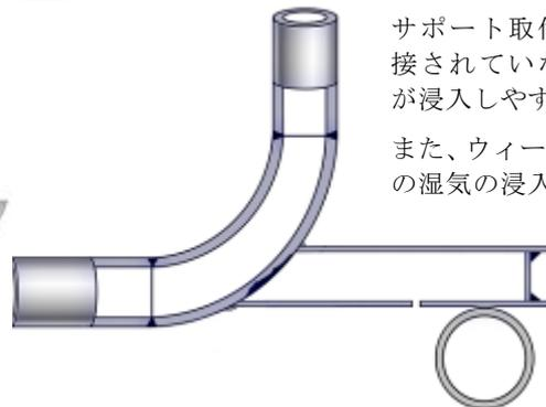
サポート取付部が全周溶接されていない場合雨水が浸入しやすい。
