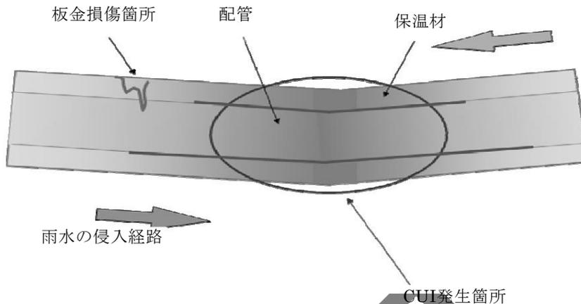
図-12 水平配管垂れ下がり部のCUI
