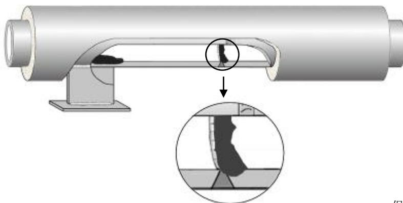
サポート取付部はフィン効果による局部冷却により、優先的に腐食されやすい。
