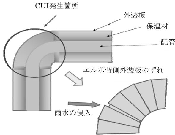
図-10 配管エルボ背側の外装板の損傷箇所部のCUI
