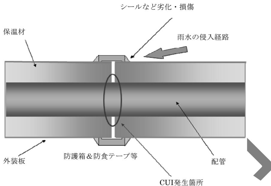
図-8 保温材連結部のシール不良箇所のCUI
