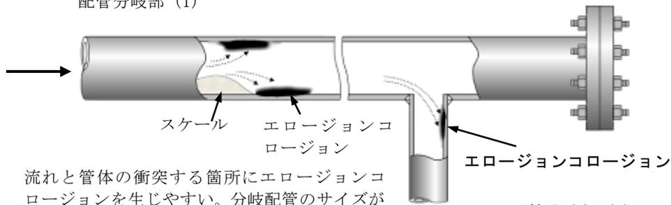
流れと管体の衝突する箇所にエロージョンコロージョンを生じやすい。分岐配管のサイズが減少する場合、流れが絞られるため、上流配管にスケールが堆積しやすく、その近傍にエロージョンコロージョンを発生することがある。
