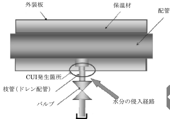
図-14 (枝管等の接続配管) 保温施工目地部のCUI
