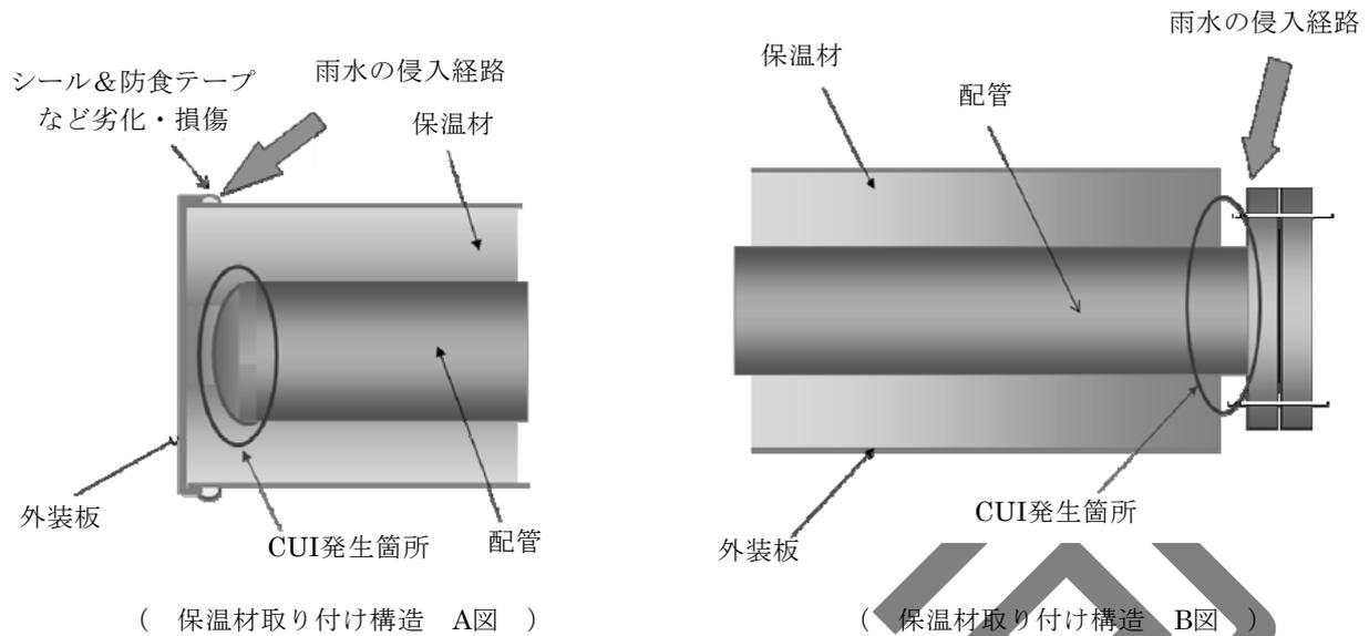
図-6 保温配管末端部のCUI
