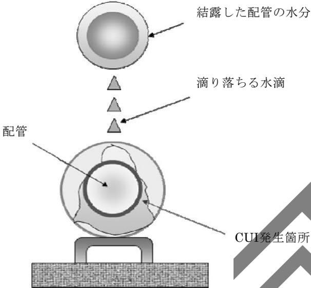
図-16 水滴直下に位置する保温配管のCUI (その2)
