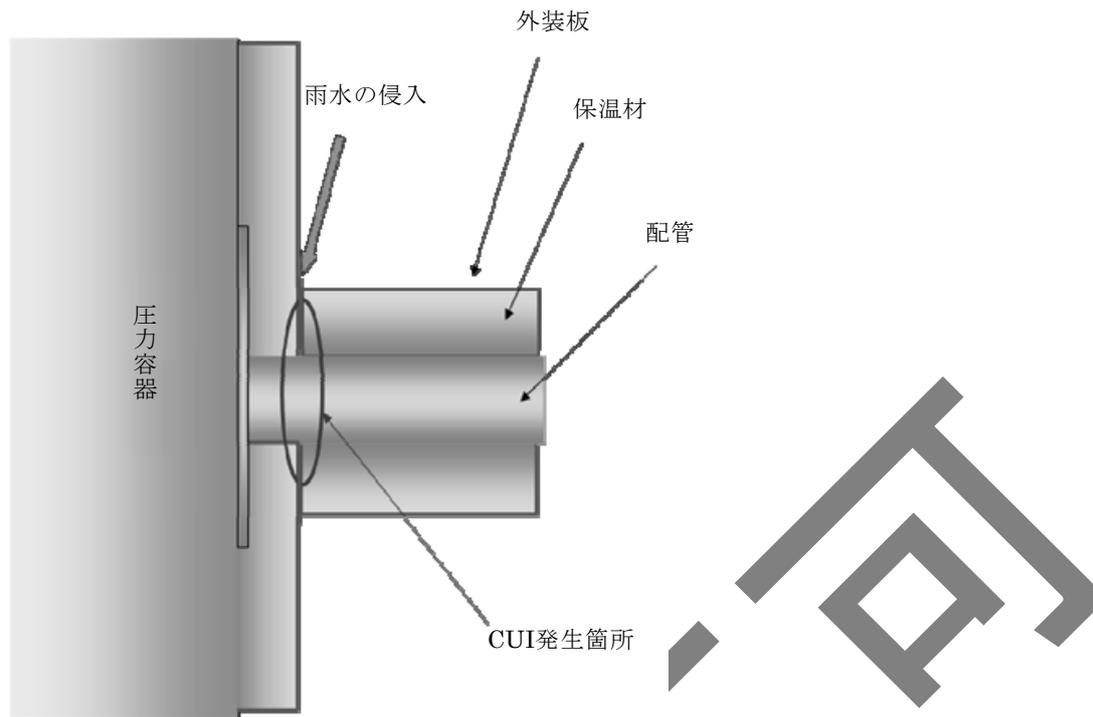
( 保温材取り付け構造 A図 )
