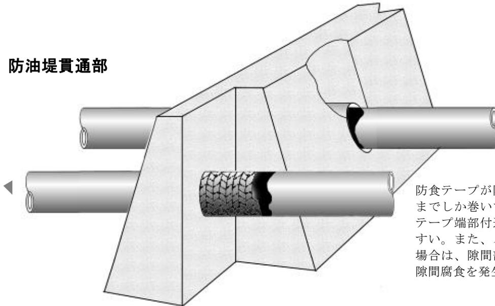
防食テープが防油堤内又は法面までしか巻いてない場合、防食テープ端部付近に腐食を受けやすい。また、スリーブタイプの場合は、隙間部に雨水が浸入し隙間腐食を発生しやすい。
