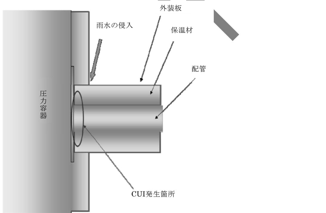
( 保温材取り付け構造 B図 )
