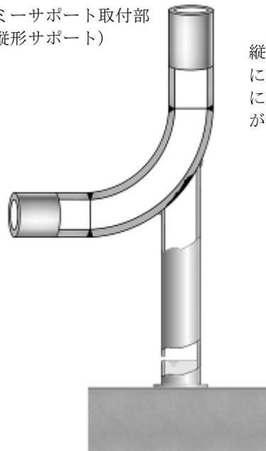
縦形でも、上図と同様に、雨水又は湿気の浸入によりエルボーの背面が腐食される。
