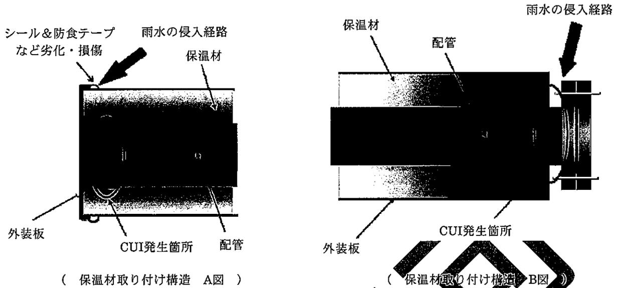
図-6 保温配管末端部のCUI
