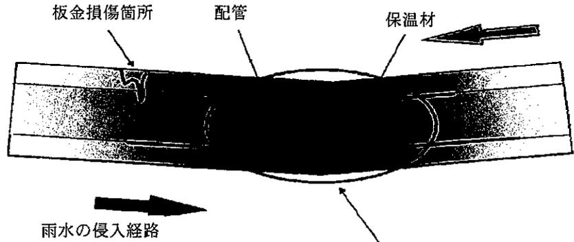
図-12 水平配管垂れ下がり部のCUI
