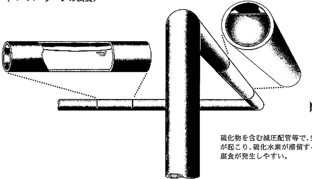
硫化物を含む減圧配管等で、気液分離が起こり、硫化水素が滞留する上部に腐食が発生しやすい。
