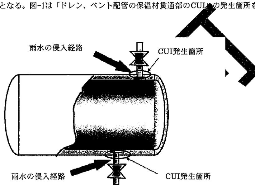
図-1 ドレン、ベント配管の保温材貫通部のCUI
