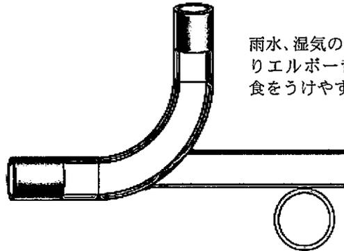
雨水、湿気の浸入によりエルボー背面に腐食をうけやすい。
