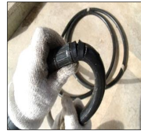
1箇所繰返し使用による割れ
