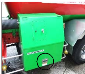
操作箱のロック装置
