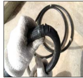
1箇所繰返し使用による割れ
