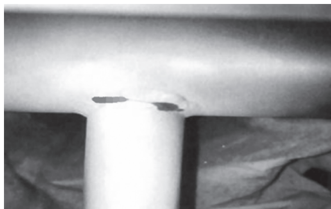
図2 蒸発器の冷媒コイルの溶接継手(ヘッダーとコイル)の浸透探傷試験結果
