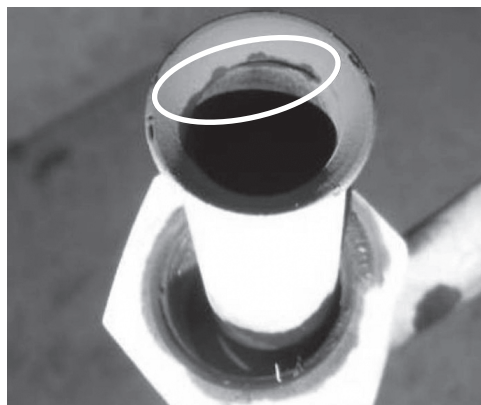
図4 配管継手(フレア式継手)の亀裂発生箇所
