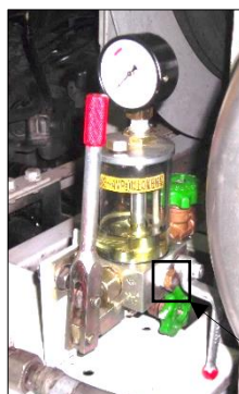
緊急遮断弁のヒューズメタル
