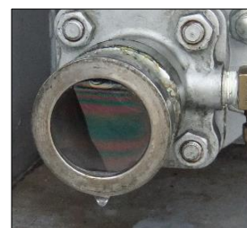
発泡液の膜 (シャボン玉の原理)
