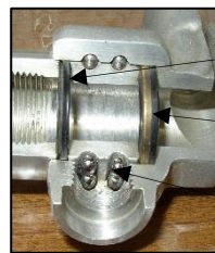
パッキン(1枚のパッキンでガスの漏れを止めている。)
