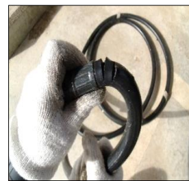
1箇所繰返し使用による割れ
