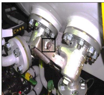
緊急遮断弁のヒューズメタル
