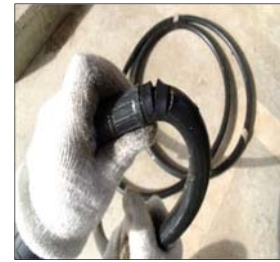
1箇所繰返し使用による割れ
