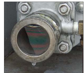
発泡液の膜 (シャボン玉の原理)
