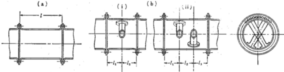
**23.3.10 発生器の波形炉筒** 波形炉筒でその端の平行部の長さが230 mm未満のものの厚さは、次の算式により得られる厚さ以上のこととすること。（図23-12 参照）
