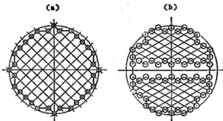
(6) 図23-8(a)及び(b)に示すように、管板に平板の役目を受け持たせた構造の管板の最小厚さは、
