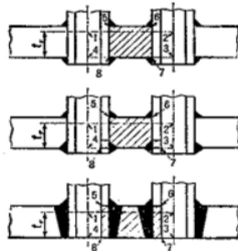
$$5678 \text{ の面積} \geq 1234 \text{ の面積} \times 0.7F$$
