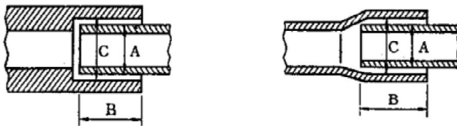
ただし、一般の管継手以外のろう付けで最小はまり込み深さが上表によれない場合は、JIS Z 3192 (1999) ろう付継手の引張及びせん断試験方法によってせん断強さを確認したろう材と母材の組合せを使用し、JIS Z 3621 (1992) ろう付作業標準によってろう付けする場合に限り、次の算式による。
