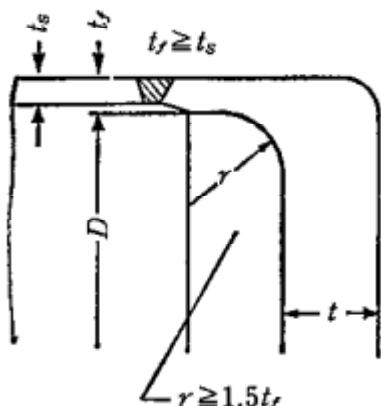
法兰ジ付きの平板が胴と一体成形され、又は胴に突合せ溶接される場合
