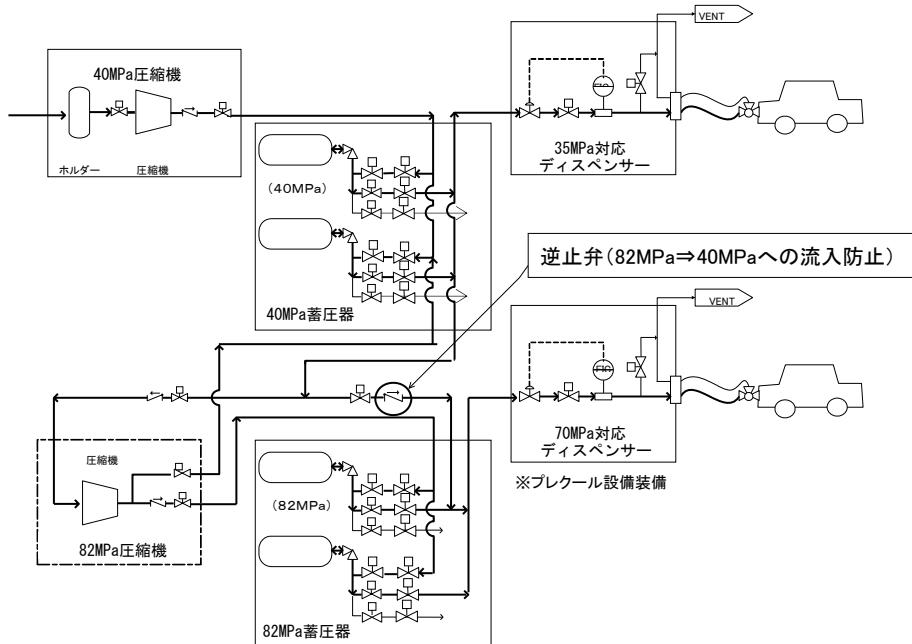
図1 蓄圧器による差圧充填方式
