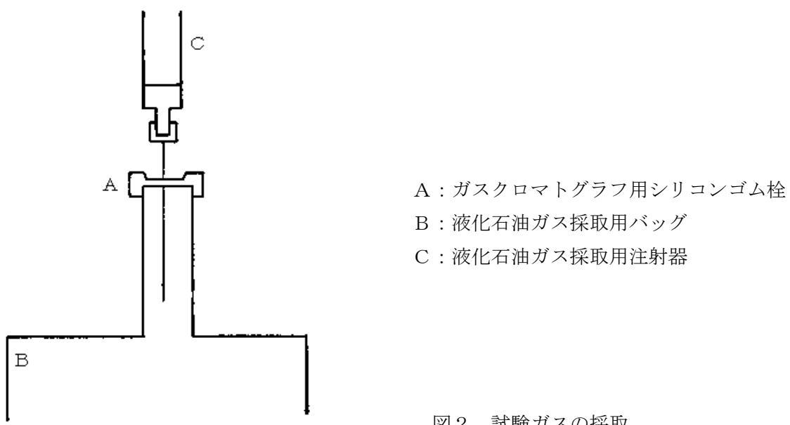
図2 試験ガスの採取
