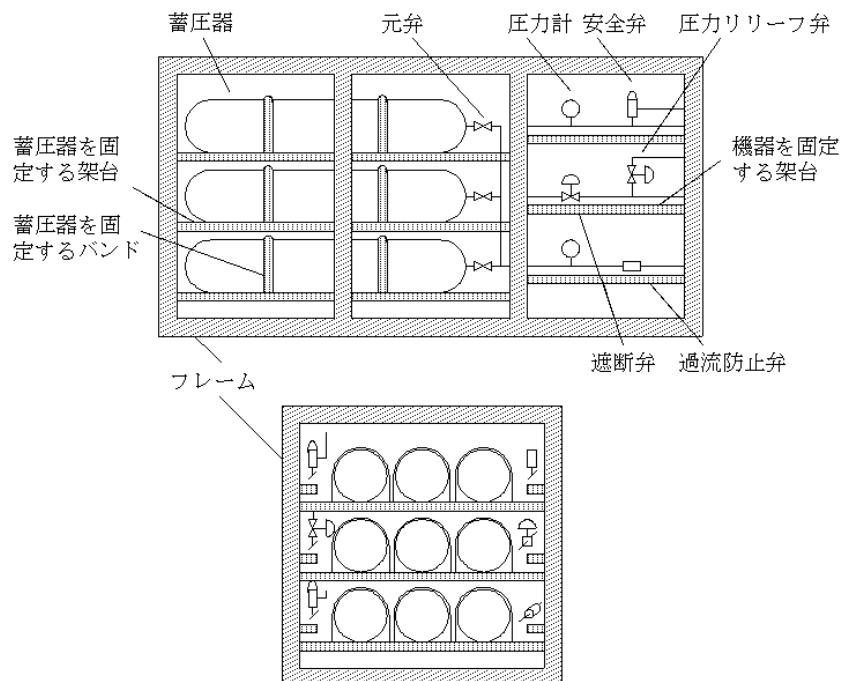
図1 同一フレームへの取り付け方法例
