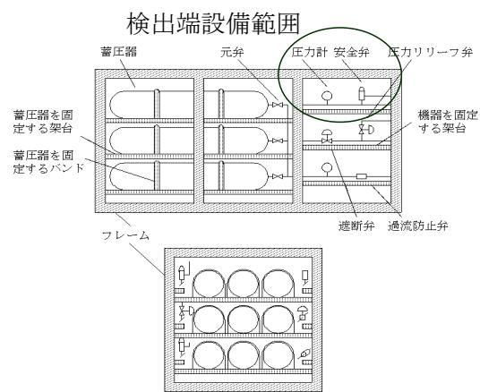
図 2 蓄圧器等配管集合部への設置例
