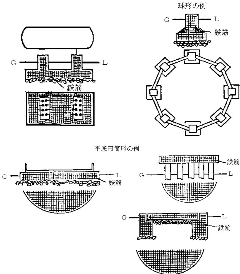
8.2 貯槽を基礎に緊結する方法は、次の基準の例によるものとする。
