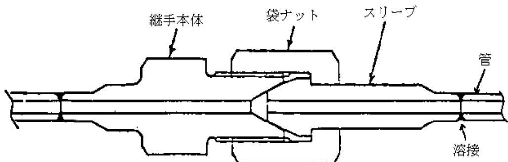
図4 小口径高圧用管継手型式
