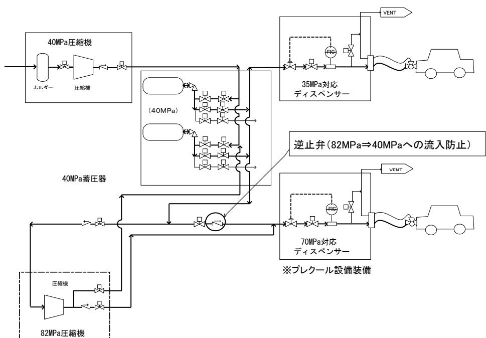
図2 圧縮機による直列押込み充填方式
