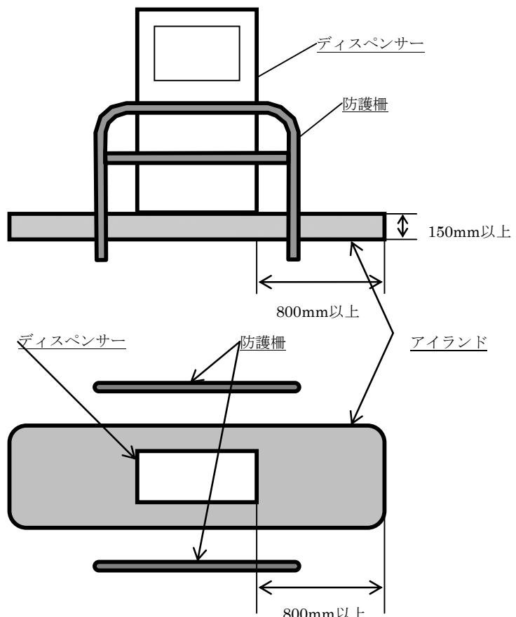
図 車両衝突防止措置の設置例
