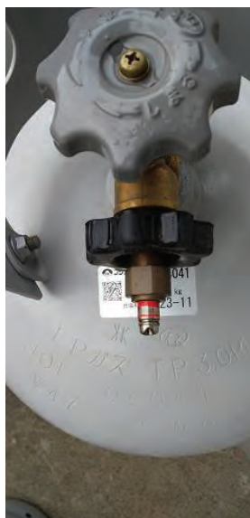
（中）高圧ホースがちぎれているが、張力式の高圧ガス放出防止機構が作動している
