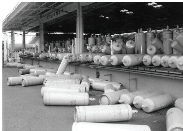
東日本大震災の地震で倒れプラットフォームから落下した LP ガス容器（石油産業新聞社提供）
