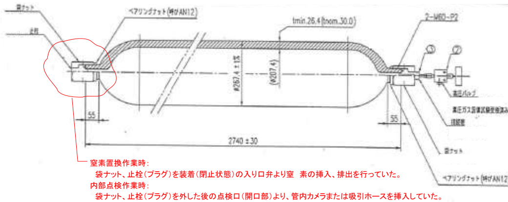
図2 開放検査時の蓄圧器の概要
