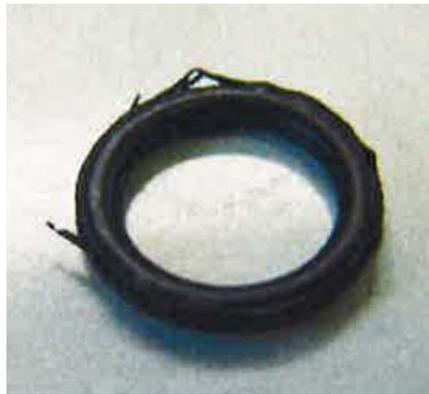
写真 損傷したOリング
