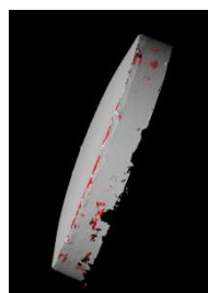
三次元形状測定器による閉止板の形状測定
